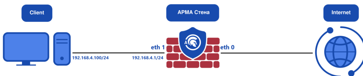
Рисунок – Схема стенда для настройки прокси-сервера
