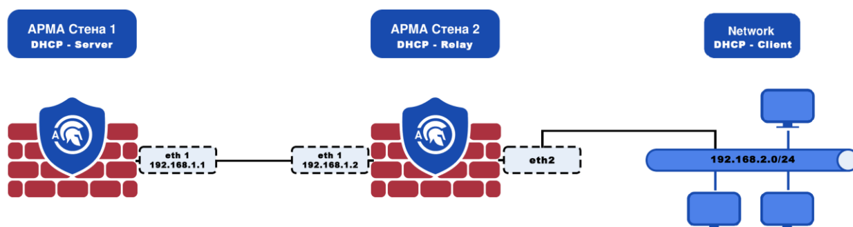
Рисунок – Схема стенда для настройки DHCP-ретранслятора
