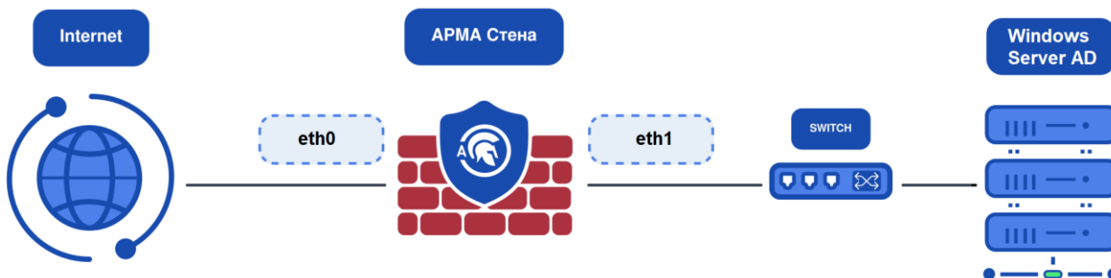
Рисунок – Схема стенда для настройки Multifactor Radius Adapter - Windows
